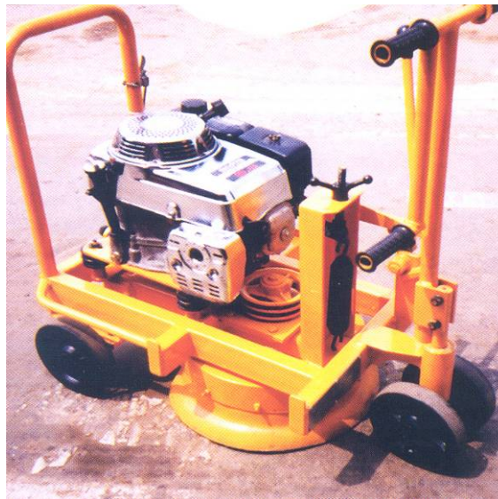
ภาพที่ 30 ภาพเครื่องจักรกลสำหรับลบเครื่องหมายจราจรบนผิวทาง
