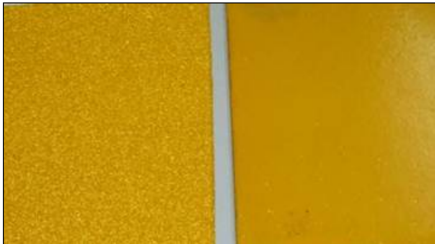
ภาพที่ 1 แสดงข้อแตกต่างระหว่างวัสดุเทอร์โมพลาสติก ที่ผสมลูกแก้ว 30 % กับ ไม่มีลูกแก้ว
