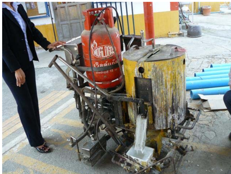
ภาพที่ 20 เครื่องตีเส้นจราจร สำหรับเครื่องแบบริดหรือปาดลาก
