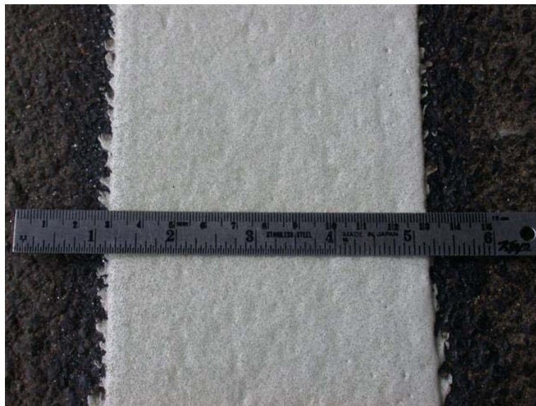
ภาพที่ 40 ภาพแสดงการวัดความกว้างของสีเทอร์พลาสติก
