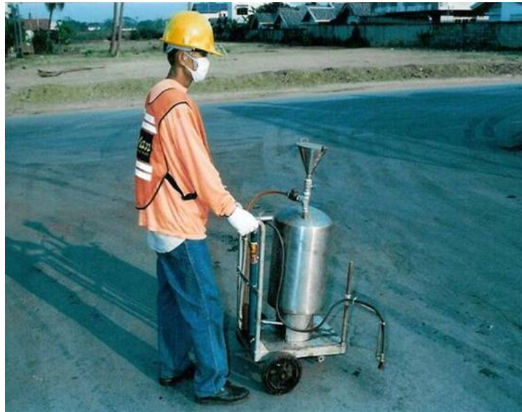
ภาพที่ 26 เครื่องพ่นวัสดุรองพื้น (Tack Coat หรือ Primer)
