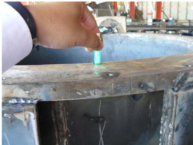
ภาพที่ 23 แสดงความหนาของหม้อตุ๋น และช่องใส่ Hot Oil
