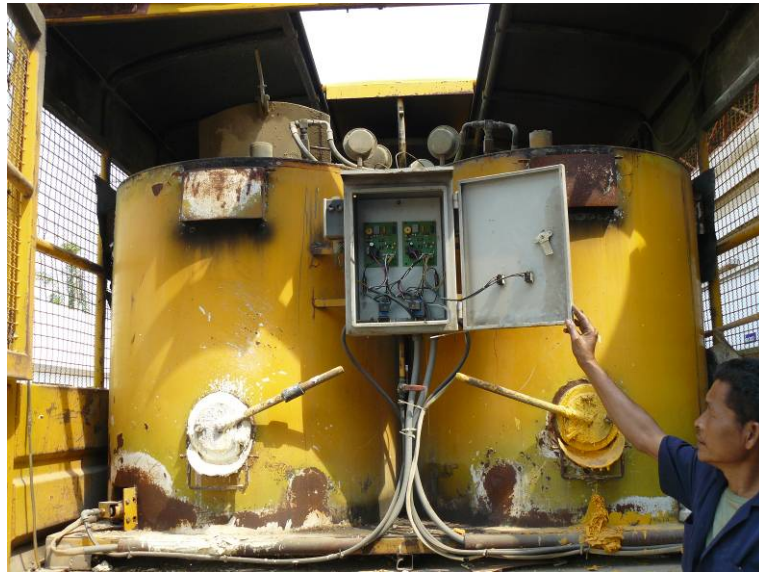
ภาพที่ 22 หม้อต้มกวนวัสดุเทอร์โมพลาสติก (หม้อตุ๋น )
