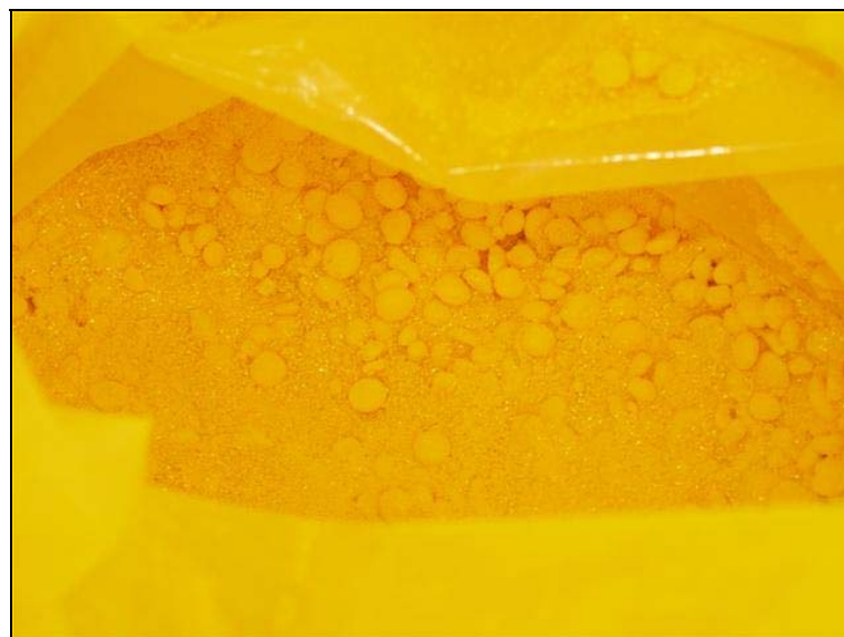
ภาพที่ 3 วัสดุเทอร์โมพลาสติกต้องมีลูกแก้วผสมอยู่ในเนื้อสี 30 % (สังเกตได้)
