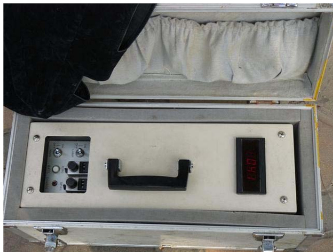
ภาพที่ 28 เครื่องวัดแฟลคเตอร์การสะท้อนแสง ในเวลากลางคืน (Retro reflectivity)
