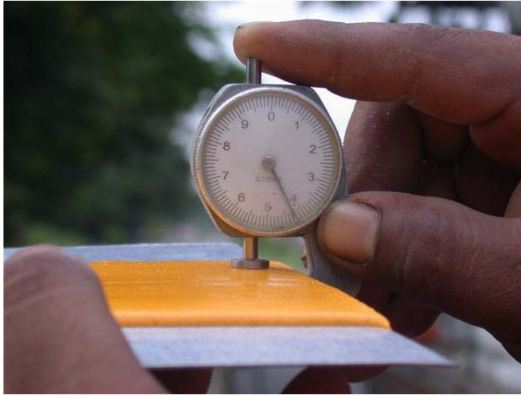
ภาพที่ 41 ภาพแสดงการวัดความหนา ตามที่กำหนดโดยใช้แผ่นโลหะผิวเรียบ
