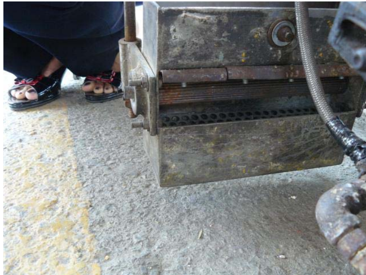
ภาพที่ 21 เครื่องโรยลูกแก้ว แบบระบบเฟือง (โรยลูกแก้วได้สม่ำเสมอ)
