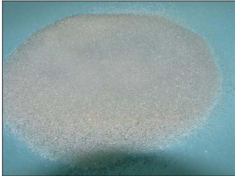
ภาพที่ 5 ลูกแก้วผสมต้องมีมวลละเอียดดีและมีความวาวสะท้อนแสง
